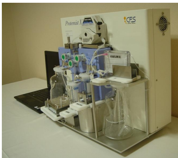
Protemist® XE (本体: W x D x H=52.5 X 31 X 49.5cm 重量 約20kg)
